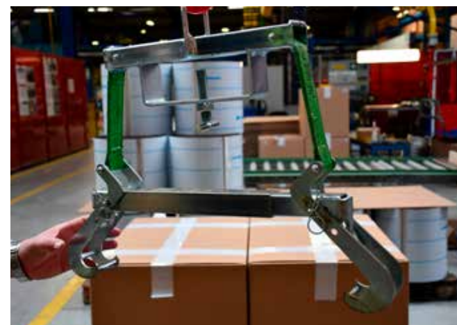
Packo Inox zorgde zelf voor de gripper op de manipulator, perfect afgestemd op hun product.
