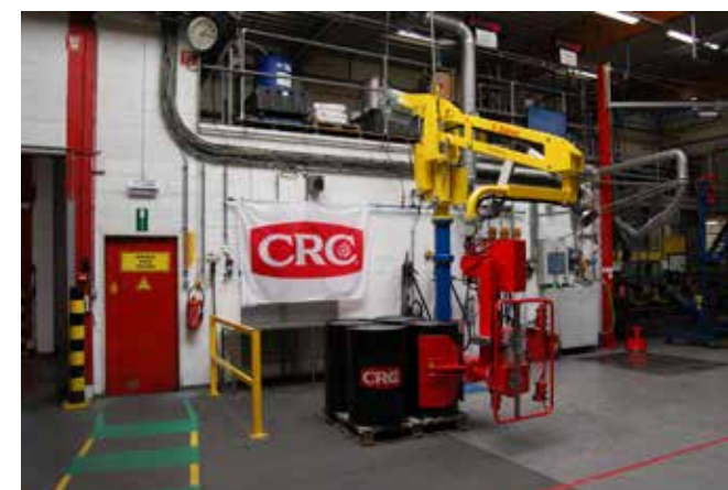
Het vat kan veilig op de vloer gelegd worden, zonder de gripper of de vloer te beschadigen.
